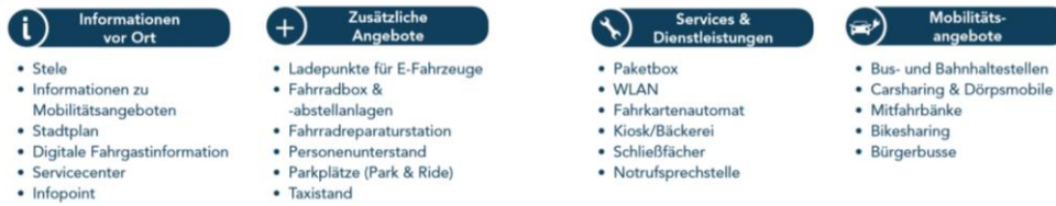
Abbildung 39: Aufbau und mögliche Bestandteile einer Mobilitätsstation
